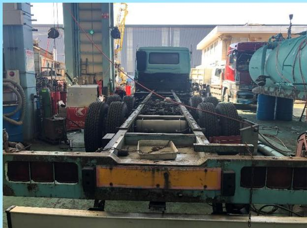
大型タンクローリーに乗っているタンク部分は約30年もつと言われていています。しかしそれを運ぶトラックはもって約10年。使えるタンクを活かし、トラック部分だけを取り替えられれば、大幅なコストダウンになります。見た目新品同様に磨き仕上げたタンク！新しいシャーシー！低コストで新車の輝きです！
